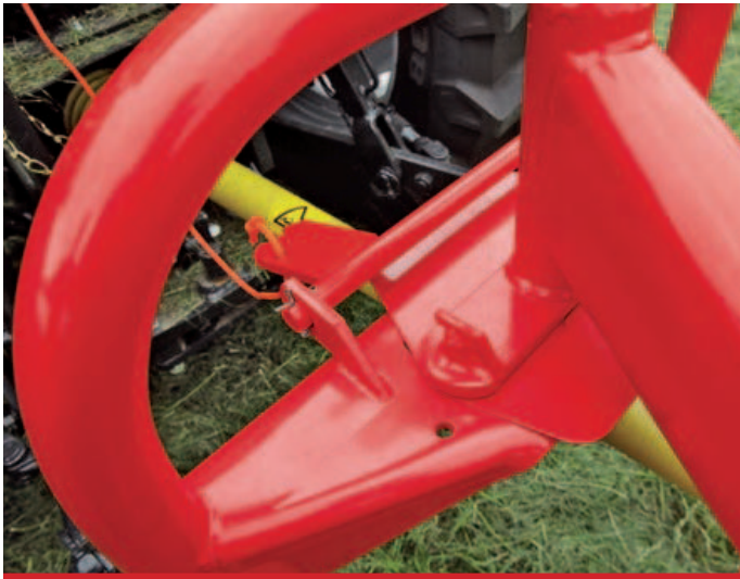
Attacco 3 punti flotante. / Pivoting headstock. / Cabezal de enganche pivotante. / Attelage flottant à 3 points.
