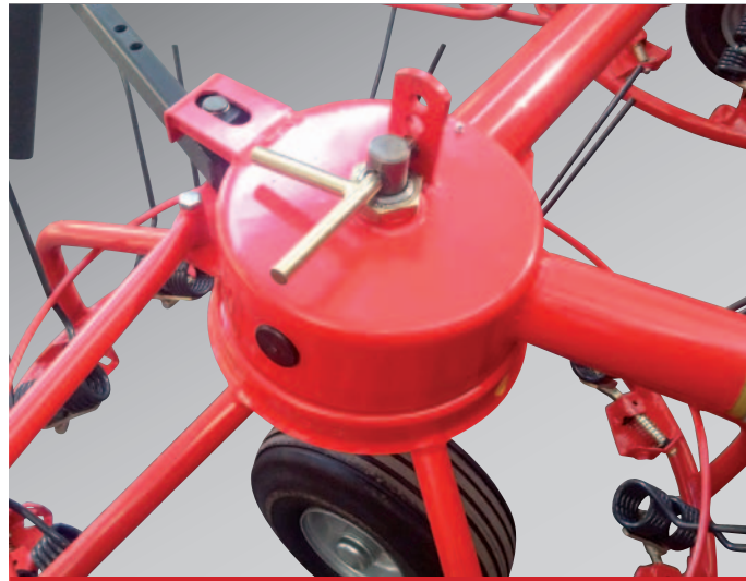
Regolazione altezza al lavoro. / Working height adjustment. / Regulacion de altura de trabajo. / Réglage hauteur de travail.
