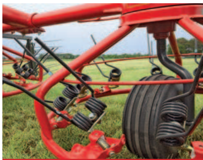
Ampi pneumatici scanalati. / Wide ribbed tyres. / Neumaticos anchos acanalados. / Pneus large et striées.
