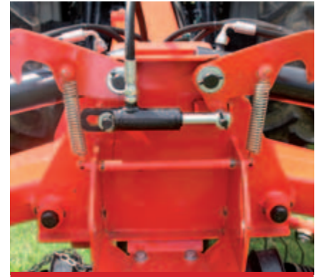
Blocco meccanico azionato automaticamente. / Automatic mechanical lock. / Bloqueo mecánico accionado automáticamente. / Système de verrouillage automatique.
