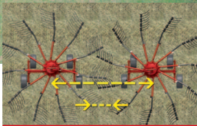
Pulizia completa del terreno grazie all'intersezione dei bracci andana. / Complete cleaning of the ground thanks to the intersection of the arms. / Completa limpieza del terreno gracias a la intersección de los brazos. / Nettoyage complet du sol grâce à l'intersection des bras.
