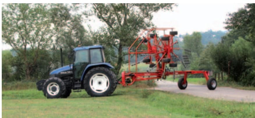
Grande manovrabilità grazie al sistema di sterzata. / Steering System allows great maneuverability. / Gran maniobrabilidad gracias al sistema de dirección. / Système de direction qui permet une grande manoeuvrabilité.
