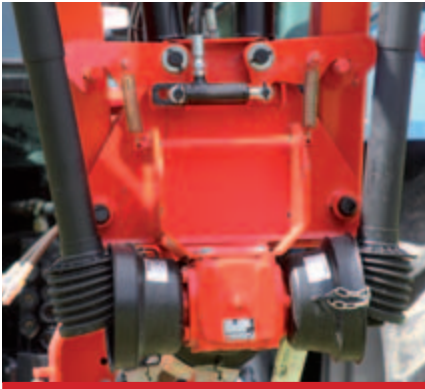
Trasmissione a cardano. / Cardan shaft. / Transmisión con eje cardanico. / Transmission à cardan.
