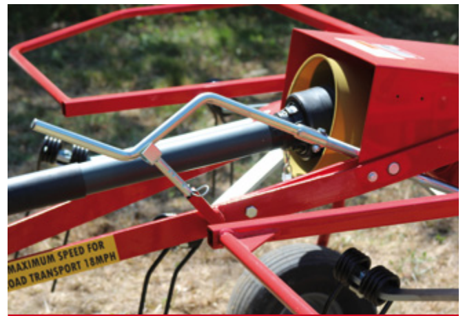
Regolazione dell'inclinazione in fase di lavoro. / Tilting adjustment during working. / Ajuste inclinación durante el trabajo. / Reglage de l'inclinaison pendant le travail.
