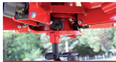
Sistema di cambio posizione da giroandanatore a voltafieno. / Position change from rake to tedder. / Cambio de sistema de rastrillo a esparcidor. / Change de position d'andaineur à faneuse.
