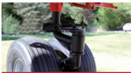
Ruote gemellate pivotanti 15,600-6. / Twin pivoting wheels. / Doble ruedas pivotantes 15,600-6. / Roues jumelées pivotantes 15,600-6.
